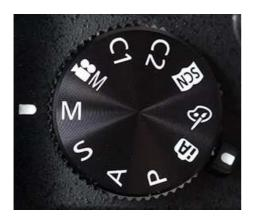
Stellen Sie die Kamera auf den "M-Modus". Dieser wird über ein Drehrad eingestellt.
