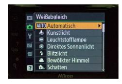
Der Weißabgleich ist für die korrekte Farbe im Bild zuständig. Dieser muss bei Studioaufnahmen idealerweise manuell eingestellt werden.
